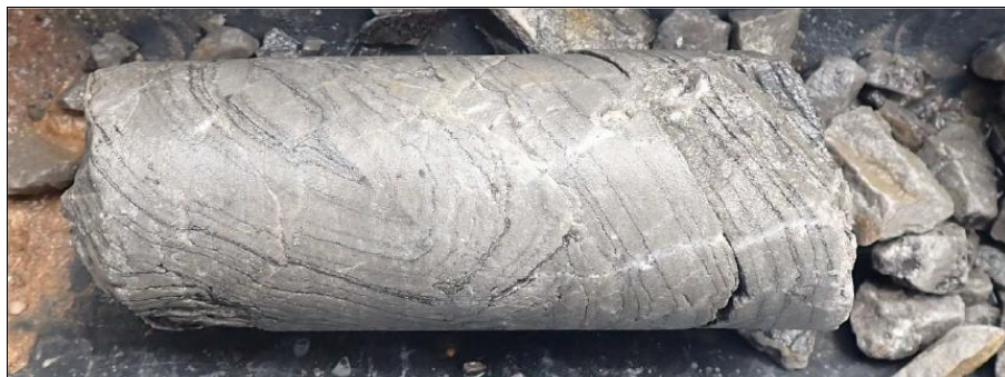
Obr. 6 Detail zvrásněného křemence zastiženého ve vrtu J13.
