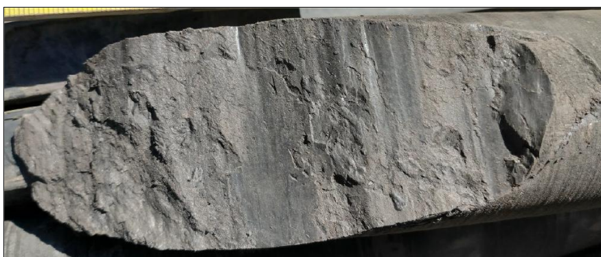
Obr. 8 Detail povrchu diskontinuity s ohlasy a rýhováním v břidlici vinického souvrství ve vrtu J10 .
